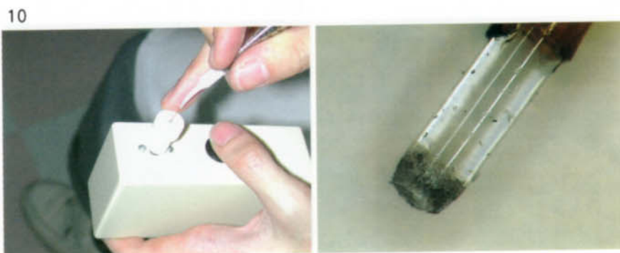
写真10 ファイバーの先端を加工しているところ（左）。（右）は加工後のファイバー先端拡大。
